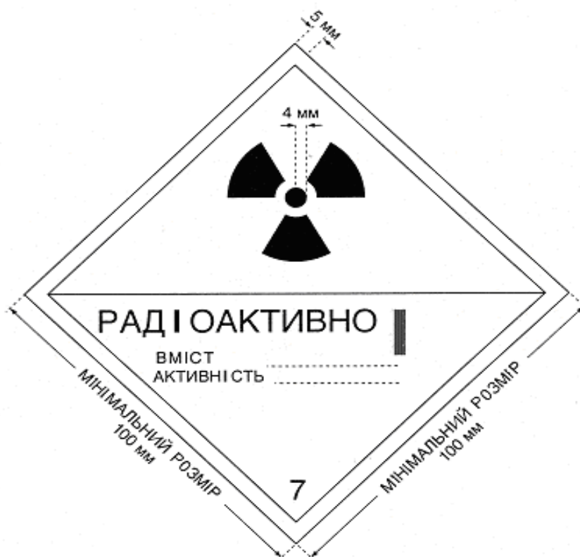
Рис. 2. Знак небезпеки категорії I-БІЛА (I-WHITE). Мінімальна ширина лінії всередині кромки, що утворює ромб, - 2 мм. Колір фону знака небезпеки – білий, колір основного знака радіаційної небезпеки (трилисника) і написів – чорний, колір смуги, що позначає категорію, – червоний.
