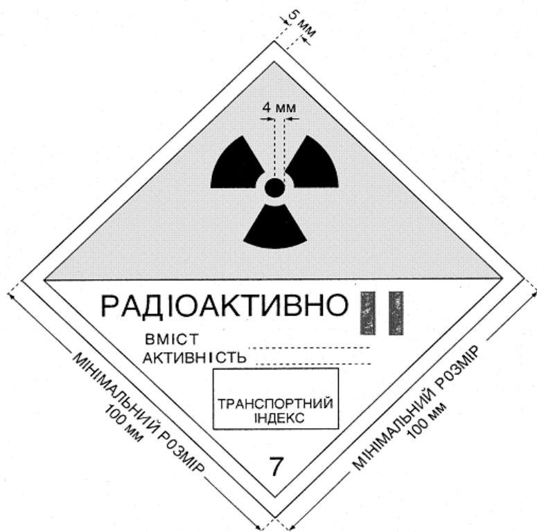
Рис. 3. Знак небезпеки категорії II-ЖОВТА. Мінімальна ширина лінії всередині кромки, що утворює ромб, - 2 мм. Колір фону верхньої половини знака небезпеки – жовтий, нижньої половини – білий, колір основного знака радіаційної небезпеки (трилисника) і написів – чорний, колір смуг, що позначають категорію, – червоний.
