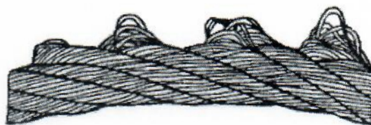
Рис. 11.5. Видавлювання дротів сталок: a – в одній сталці; б – у кількох сталках
