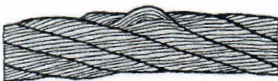
Рис. 11.5. Видавлювання дротів сталок: a – в одній сталці; б – у кількох сталках
