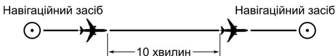
Рисунок 13 10-ти хвилинний інтервал між повітряним суднами, що знаходяться на одному й тому ж треку (лінії шляху) та ешелоні (підпункт 2 пункту 1 глави 7 розділу V)
