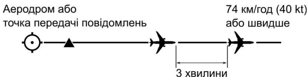
Рисунок 15 3-х хвилинний інтервал між повітряним суднами, що знаходяться на одному й тому ж треку (лінії шляху) та ешелоні (підпункт 4 пункту 1 глави 7 розділу V)
