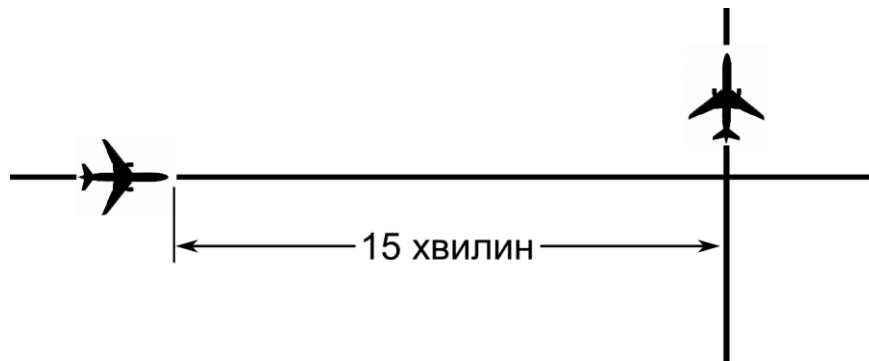
Рисунок 16 15-ти хвилинний інтервал між повітряним суднами, що знаходяться на треках (лініях шляху), що перетинаються та на одному ешелоні (підпункт 1 пункту 2 глави 7 розділу V)
