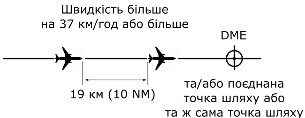
Рисунок 30 Інтервал 19 км (10 NM) між повітряними суднами, що знаходяться на одному треку (лінії шляху) та на одному ешелоні при використанні DME та/або GNSS (підпункт 2 пункту 3 глави 8 розділу V)
