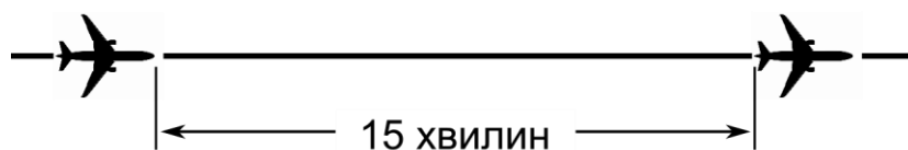
Рисунок 12 15-ти хвилинний інтервал між повітряним суднами, що знаходяться на одному й тому ж треку (лінії шляху) та ешелоні (підпункт 1 пункту 1 глави 7 розділу V)
