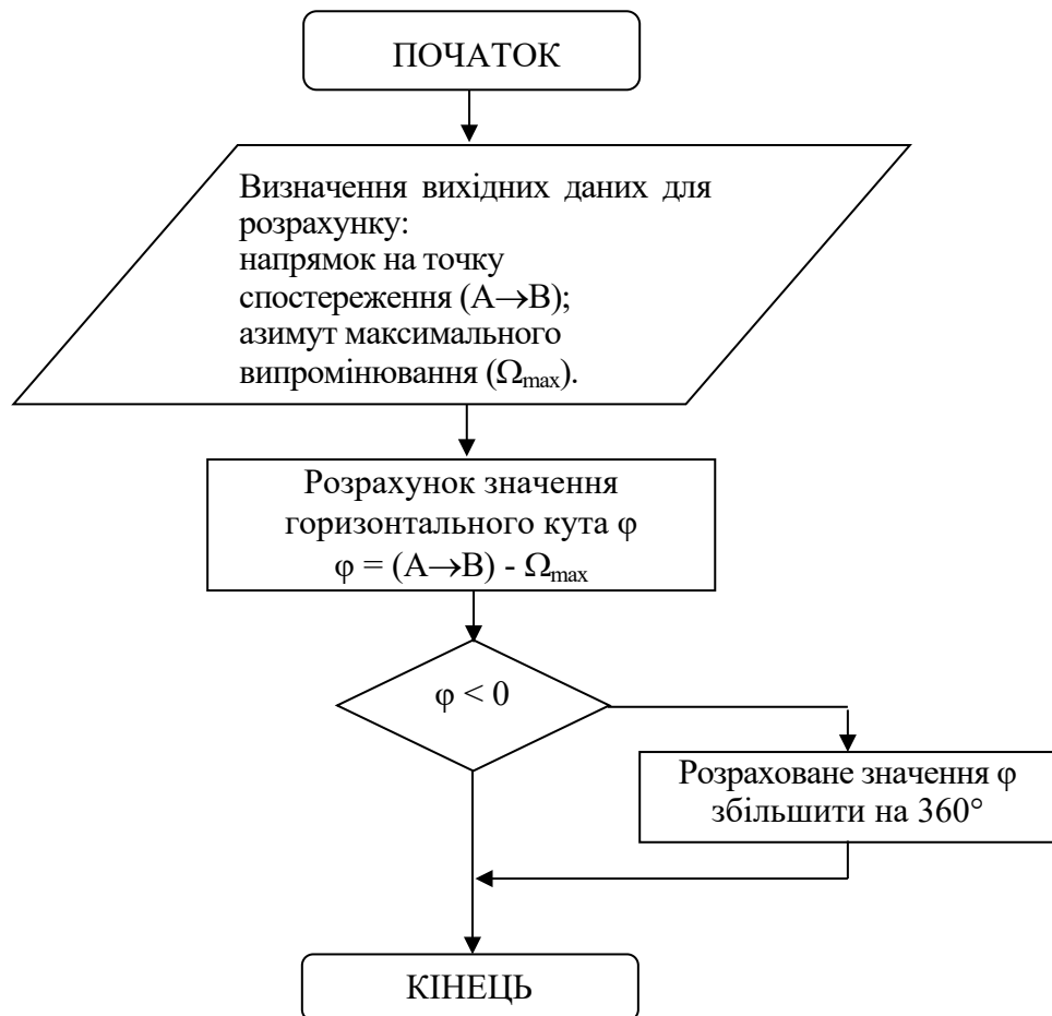
Малюнок 1. – Схема розрахунку горизонтального кута ДСА для заданої точки спостереження.
