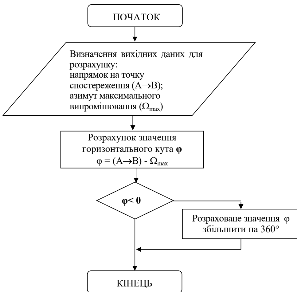
Малюнок 1 – Схема розрахунку горизонтального кута ДСА для заданої точки спостереження
